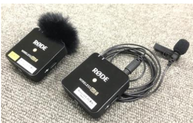
↑送信機は内蔵マイク、ラベリアマイクどちらでも録音可能です (左)内蔵マイクでの録音仕様、ファーウィンドシールド取付 (右)ラベリアマイクでの録音仕様、Lavalier GO、風防、横ピン取付
