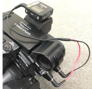
↑付属のSC2ケーブルを使い、3.5mmミニジャック端子に接続し、一眼レフカメラ等に音声の入力が可能です。(SC2ケーブルはマージモード用です、スプリットモードの場合2chの音が出れませんので、ご注意ください)
