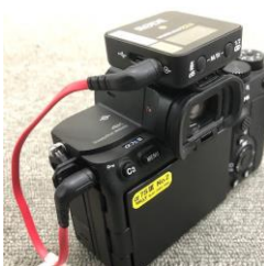
↑付属のSC2ケーブルを使い、3.5mmミニジャック端子に接続し、一眼レフカメラ等に音声の入力が可能です。(SC2ケーブルはマージモード用です、スプリットモードの場合2chの音が出れませんので、ご注意ください)
